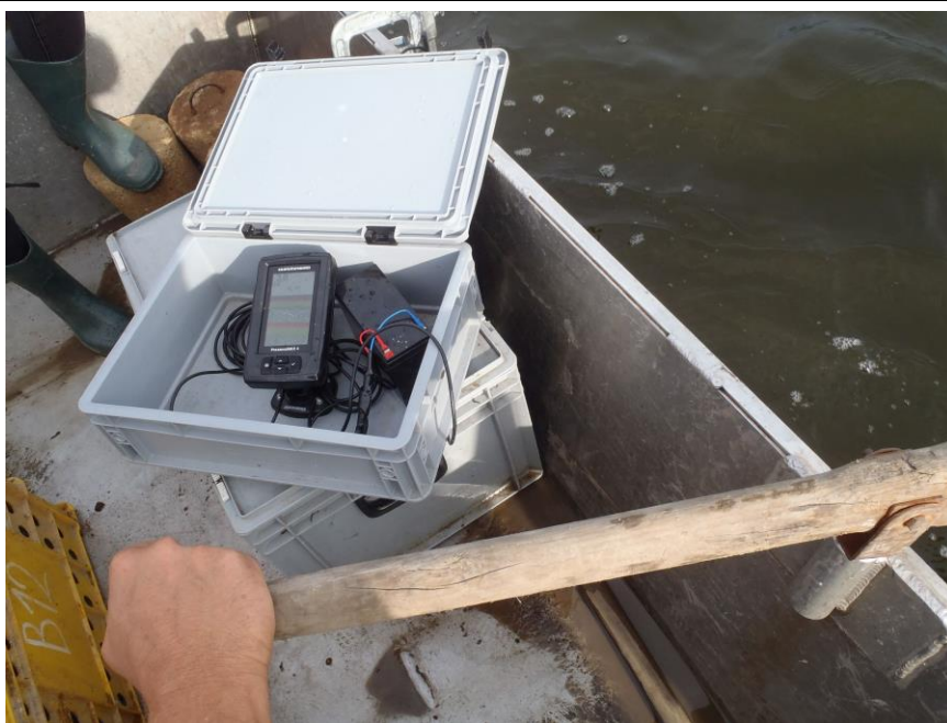
Obr. 9: Každá síť se instaluje s pomocí echolotu a GPS senzoru
