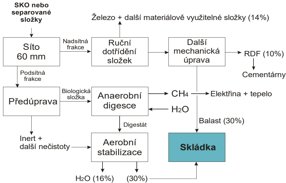
Obrázek 8-2 Příklad zjednodušeného schématu MBU s anaerobním stupněm využívání biologické frakce
