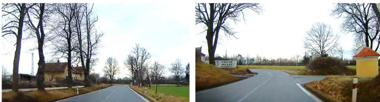
Obrázek 10: Pohled na pevné překážky ve směru staničení (vlevo stromy, vpravo navýšený ostrůvek).
